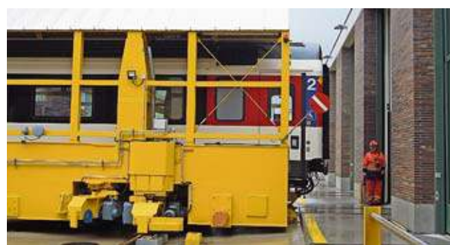
Ein Wagon wird zu einem freien Arbeitsstand geführt.
